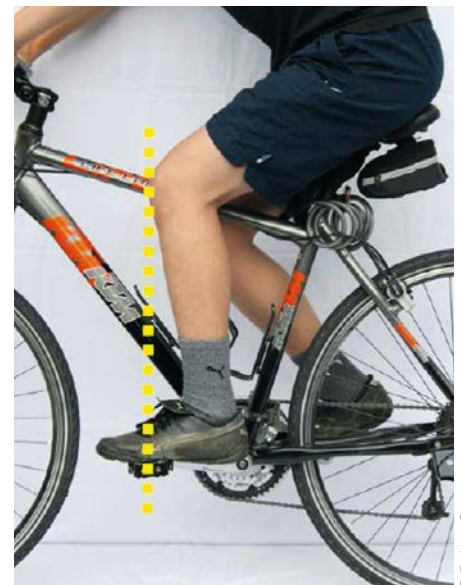
Horizontale Einstellung: Bei waagrecht Pedalstellung soll die Knie Scheibe genau senkrecht über der Pedalachse liegen, wenn der Fußballen am Pedal ist
