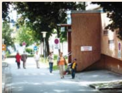
Schlecht einsehbarer Aus- bzw. Eingang (Maßnahme: Plexiglas)
