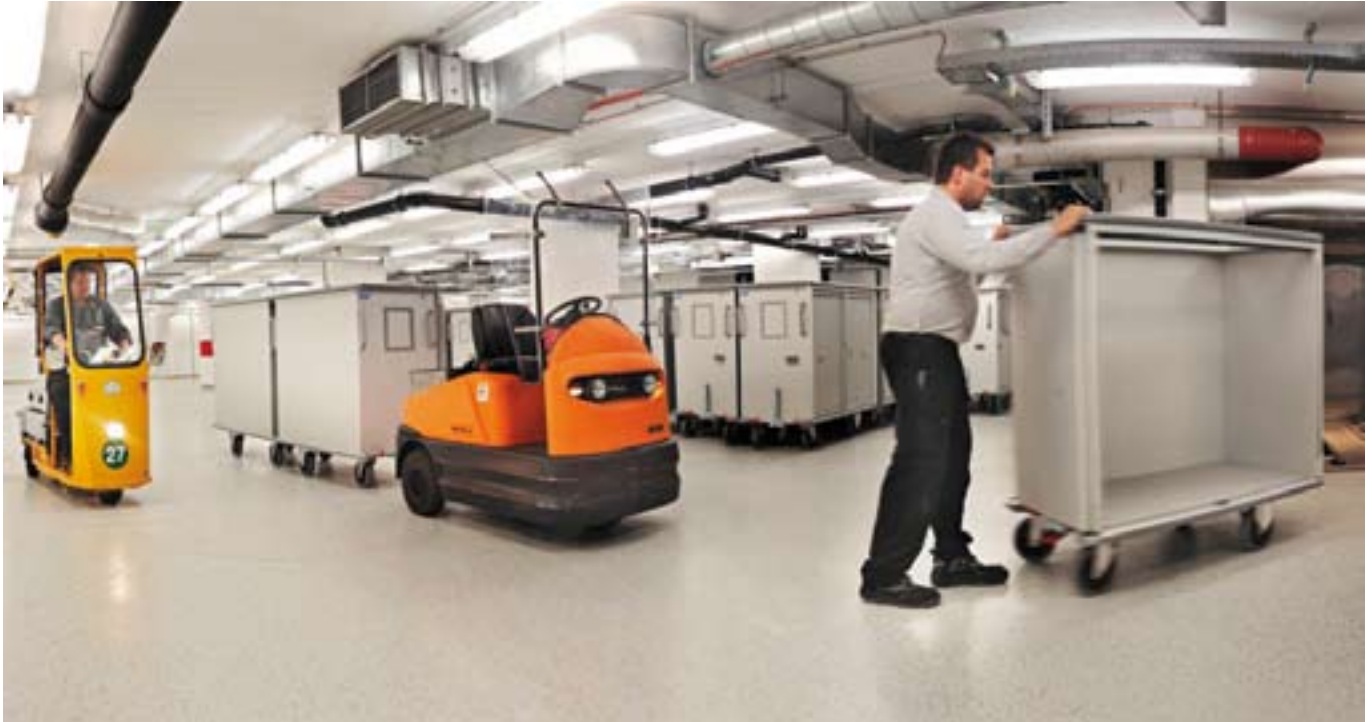
Güter werden in Containern durch den Logistiktunnel transportiert.
